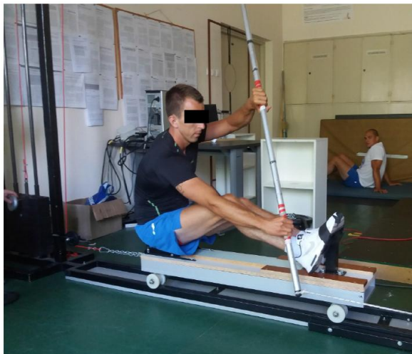
Рисунок 6 – Специальная установка для тестирования байдарочников «Single-stroke kayak test»
