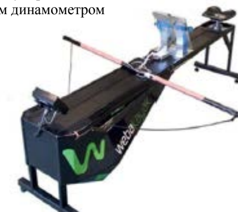
Рисунок 15. Спортивный байдарочный тренажер Weba sports с упором для ног со встроенным динамометром
