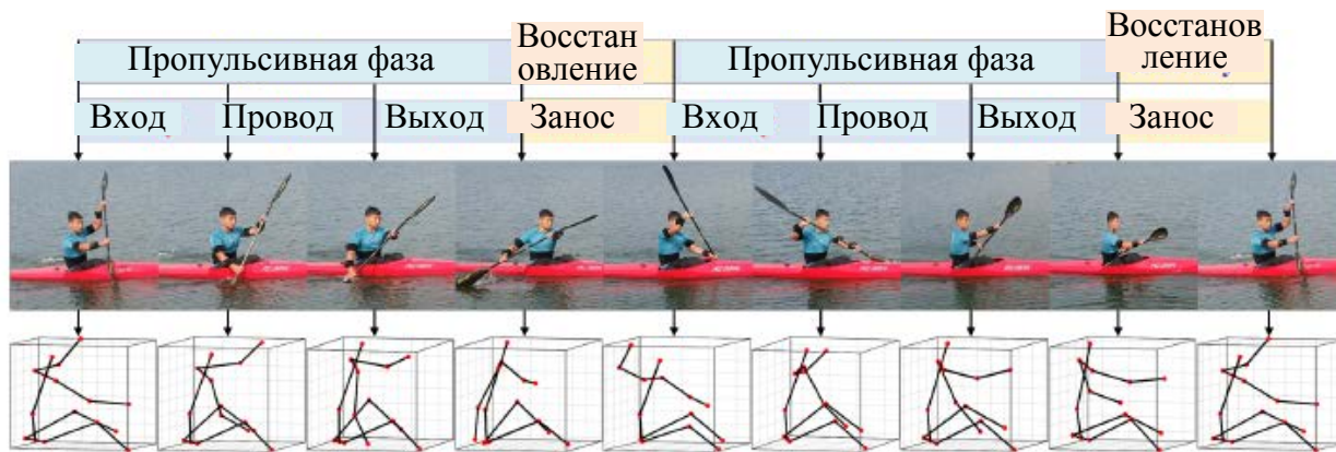
Рисунок 11. Результат реконструкции с применением инерциальной системы захвата движения
